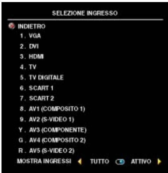
**VGA:** selezionare questa impostazione se il computer è collegato al connettore VGA. Per la posizione del connettore VGA, vedere “**Vista inferiore**” a pagina 7.
